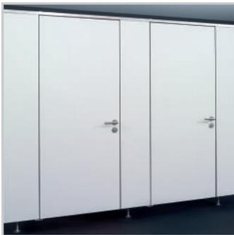
Die Systemwand saniQub mit einer Gesamtstärke von 156 mm besteht aus zwei 3 mm starken HPL-Platten (high pressure laminate) und im Inneren aus Polystyrol. Das Verbundelement mit massivem Aluminiumrahmen wird mit industrieller Präzision komplett nach den individuellen Wünschen des Kunden vorgefertigt, angeliefert und montiert.
