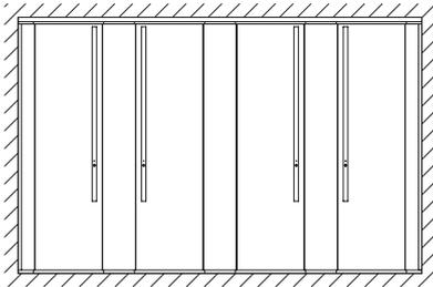
NiUU K raumhoch geschlossen – das Raum-in-Raum-System für mehr Privat- und Wohlfühlatmosphäre. Türen, Vorderfront sowie die trennenden Zwischenwände bestehen aus durchgehenden Elementen bis zu einer Höhe von maximal 2650 mm. Die Türen haben eine Bodenfreiheit von 30 mm zur Belüftung der Kabinen. Somit ist die raumhoch geschlossene Variante eine sehr elegante glattflächige Raumlösung mit perfektem Fugenbild!
