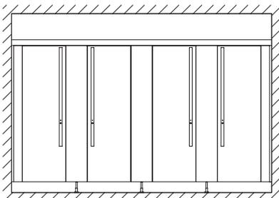
Standoptimiert – dies ist die innovative Lösung mit integrierten Füßen in den Zwischenwänden. Unsichtbar für den Betrachter, optisch perfekt und reinigungsfreundlich. Der Stabilisator bleibt als gestaltendes Element in der Front erhalten. Darüber hinaus sorgt er für erhöhte Stabilität in besonders beanspruchten Bereichen.
