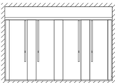
Durch einen speziell für Sanitärräume entwickelten Bodenanschluss mit filigraner Schattenfuge können auch Bodengefälle ausgeglichen werden. Das Aluminiumprofil wird massiv am Untergrund verschraubt. Die Frontelemente können so in Verbindung mit dem Stabilisator formschön und schlüssig befestigt werden. Die Trennwandhöhe liegt bei 2135 mm bis Oberkante Stabilisator.
