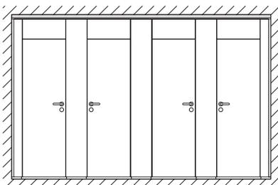
NiUU F raumhoch geschlossen – Vorderfront sowie trennende Zwischenwände sind von der Decke bis zum Boden geschlossen und bestehen aus durchgehenden Elementen bis zu einer Höhe von maximal 2650 mm. Die Türen können bis zu einer Höhe von 2300 mm reichen und haben eine Bodenfreiheit von 30 mm. Glattflächig eingefügte Oberteile über den Türen sorgen für den geschlossenen Charakter. Dies bietet dem Nutzer eine optimale Privatsphäre.
