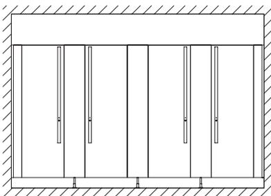
Als besonders filigrane Ausführung kann der Stabilisator auf Kundenwunsch zurückgesetzt werden. Die Füße sind ebenfalls verdeckt in die Zwischenwand integriert. So scheint die Trennwand optisch zu schweben. Diese Lösung erfüllt höchste visuelle Ansprüche.
